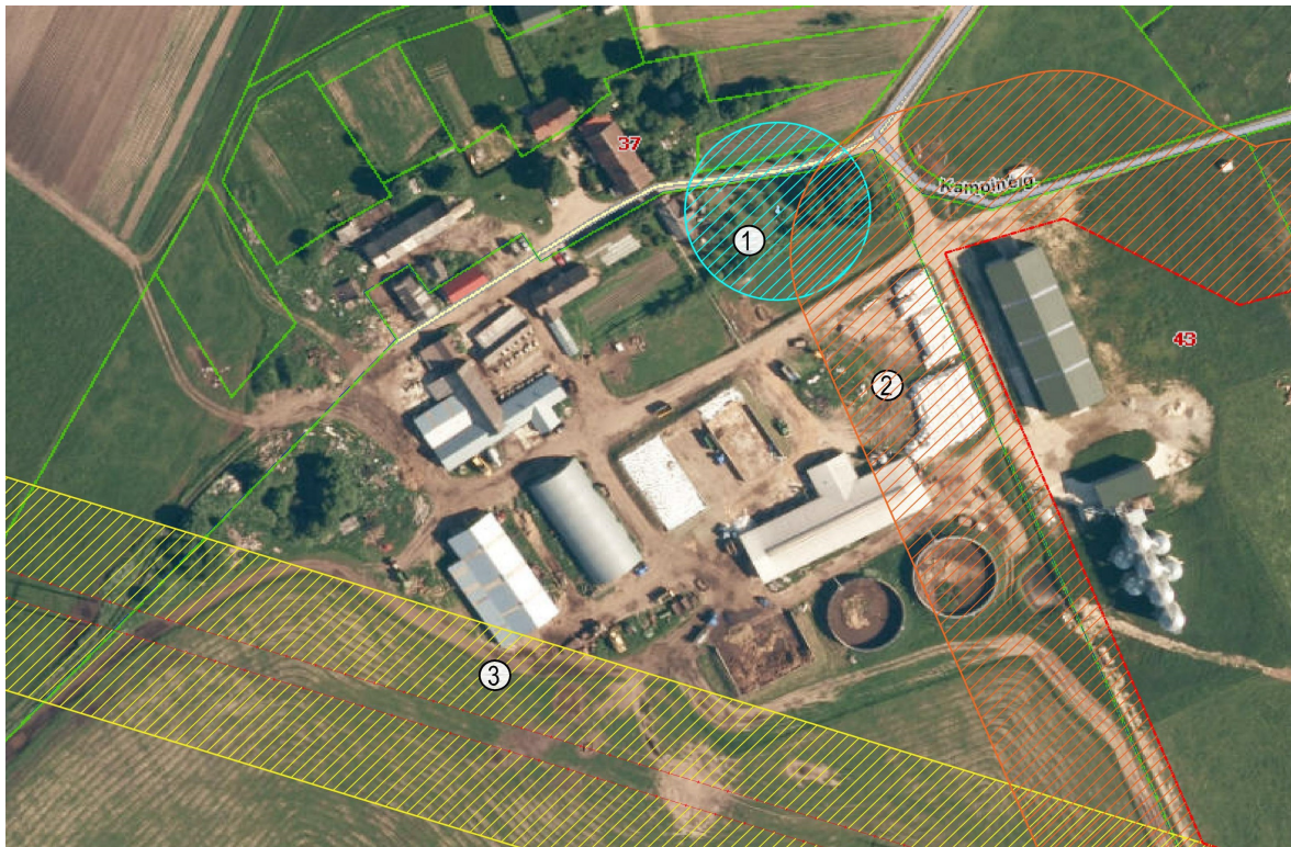
5 pav. Sklypo schema su apsaugos zonomis (1. artezinio gręžinio griežto režimo apsaugos zona – 30 m. 2. Gretimo ūkio sanitarinė apsaugos zona 3. Elektros linijų apsaugos zona).
